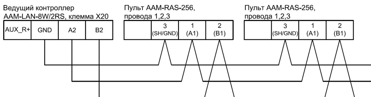
Рисунок 2. Подключение пульта ААМ-RAS-256, подключаемых на один шлейф к ведущему ААМ-LAN-8W/2RS.
