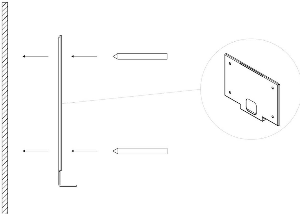
Рисунок 7. Установка кронштейна ААМ-RAS-256 на стене с помощью крепёжных шурупов.
